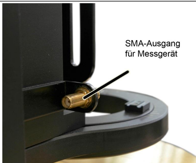
Bild 16: Anschluss des Messkabels an den SMA-Ausgang des IC-Scanners
